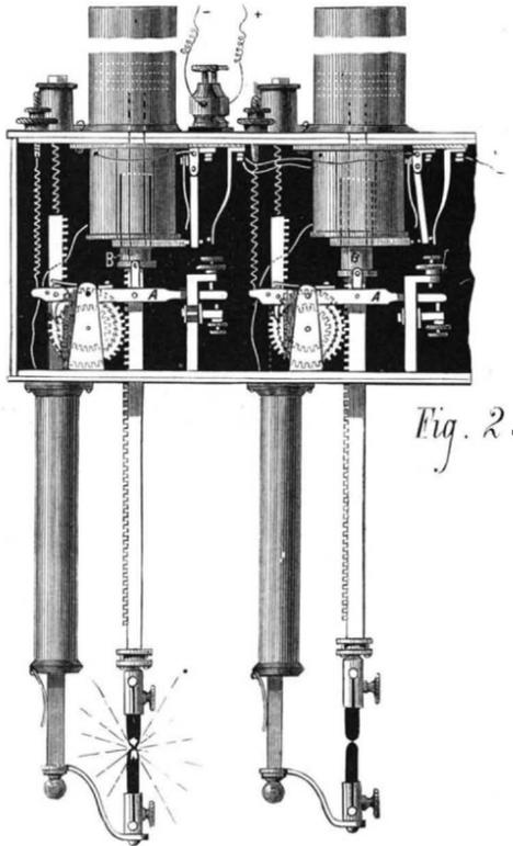
Fig. 2.—THE LEVITT-MULLER CONTINUOUS ARC LAMP.
