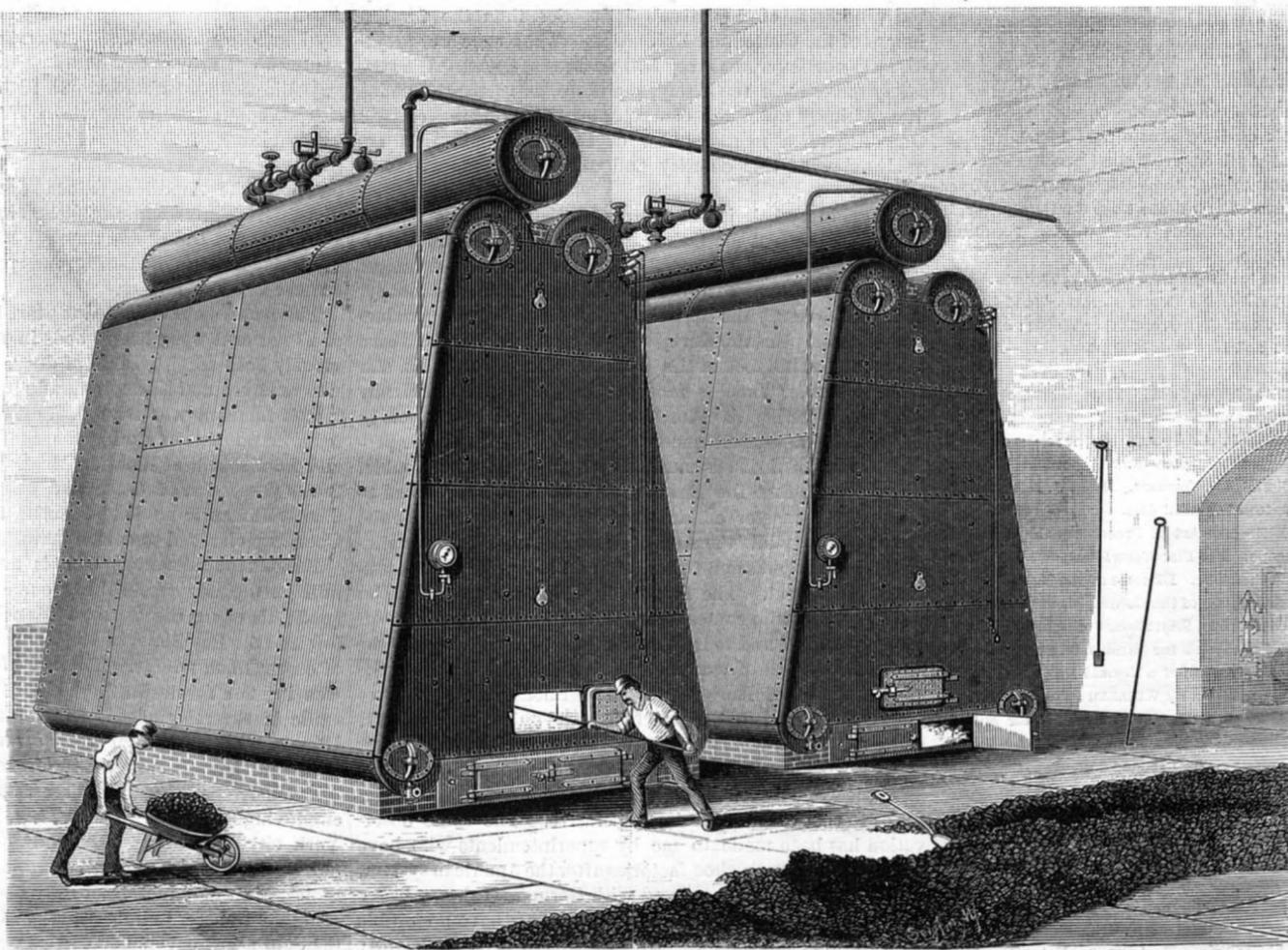
Fig. 1.—THE FIRMENICH SAFETY STEAM BOILER.
