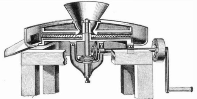
FIG. 7.—GUARDIOLA'S COFFEE HULLER FOR HAND POWER.
