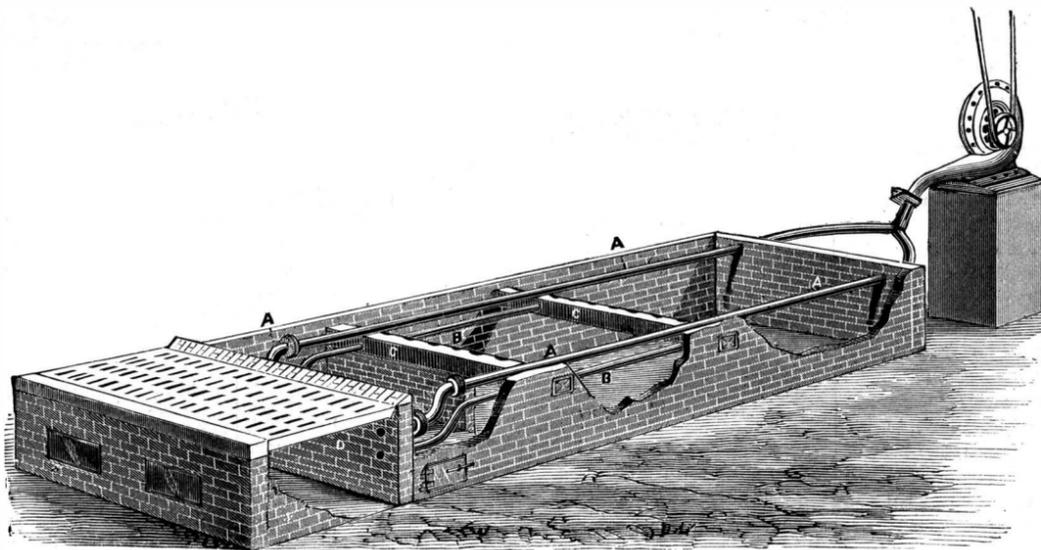
**STIRBLING'S HOT BLAST BOILER FURNACE.**
