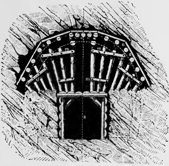
TUNNEL TIMBERING—BELGIAN SYSTEM (*a*).
