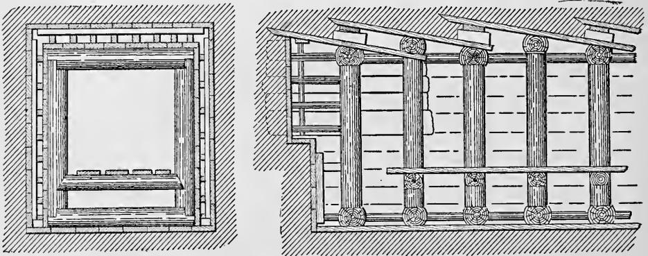
FIG 93 —TIMBERING FOR TUNNEL HEADING.
