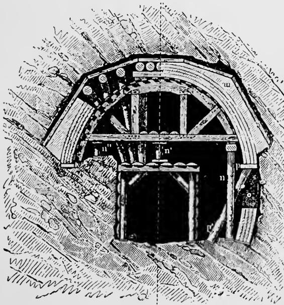
TUNNEL-TIMBERING—BELGIAN SYSTEM (*b*).
