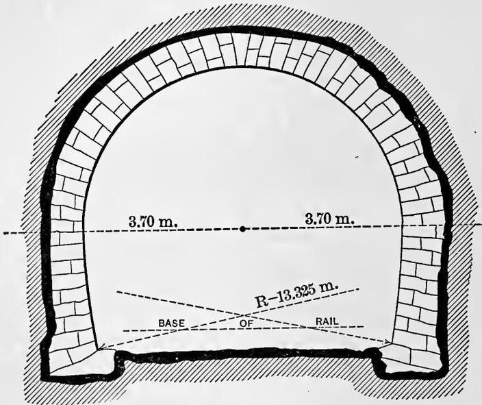
FIG. 89.—ST. CLOUD TUNNEL.
