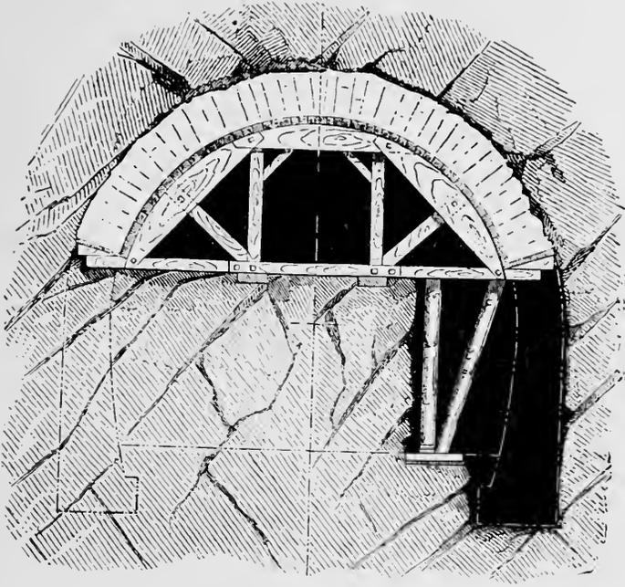
TUNNEL-TIMBERING—FRENCH SYSTEM (a).
