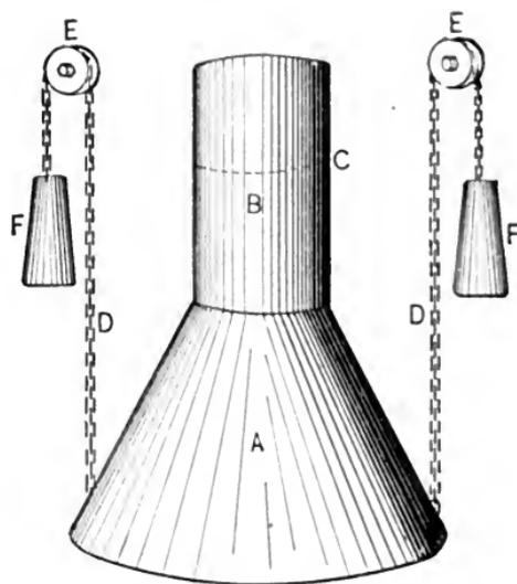
FIG. 16—THE SMOKE-STACK AND BONNET.
