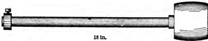
FIG. 205.—SPINDLE AND PULLEY FOR DRIVING THE FAN.
