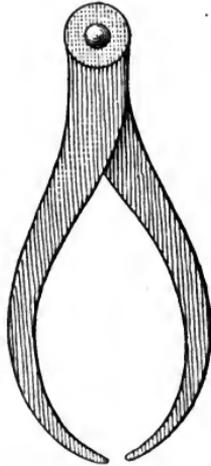
FIG. 87.—THE SINGLE CALIPERS.
