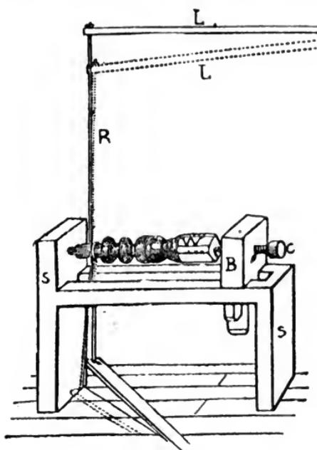
FIG. 11—A PRIMITIVE LATHE.
