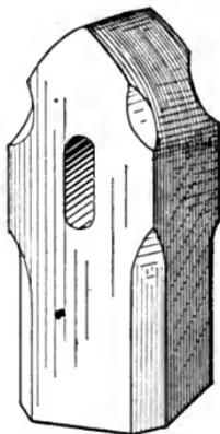
FIG. 177.—SHOWING A SLEDGE FOR HEAVY WORK.
