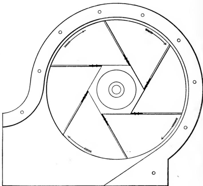
FIG. 204.—LONGITUDINAL SECTION THROUGH COMPLETED FAN.
