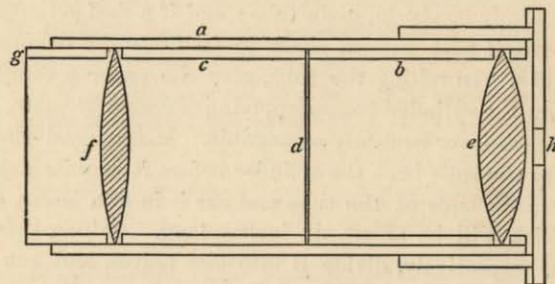
Fig. 1.—DETAILS OF THE EYEPIECE (full size).
