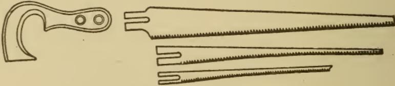
Fig. 19. Compass Saw
