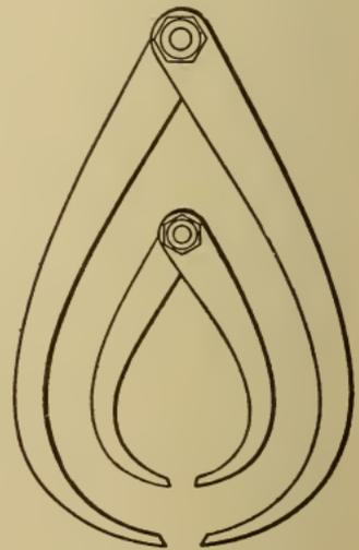
Fig. 70 Firm-Joint Calipers
