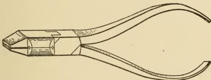
Fig. 78. Side-Cutting Pliers
