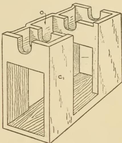
Fig. 348. Drag Pattern *c*<sub>1</sub>, Fig. 347
