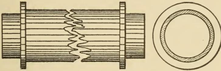
Fig. 220. Flange Pipe Pattern
