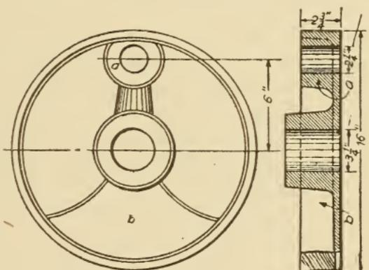
Fig. 194. Disk Crank
