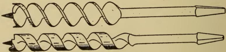
Fig. 50. Auger Bits
