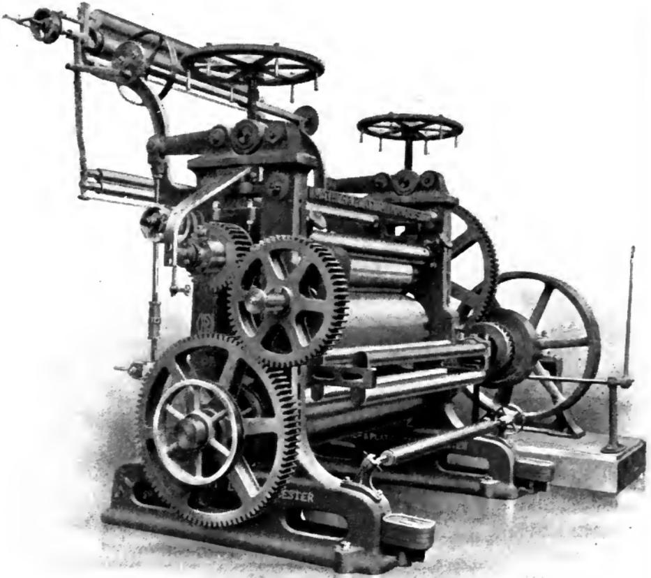
FIG. 24. 3-BOWL HEAVY FRICTION GLAZING MACHINE
