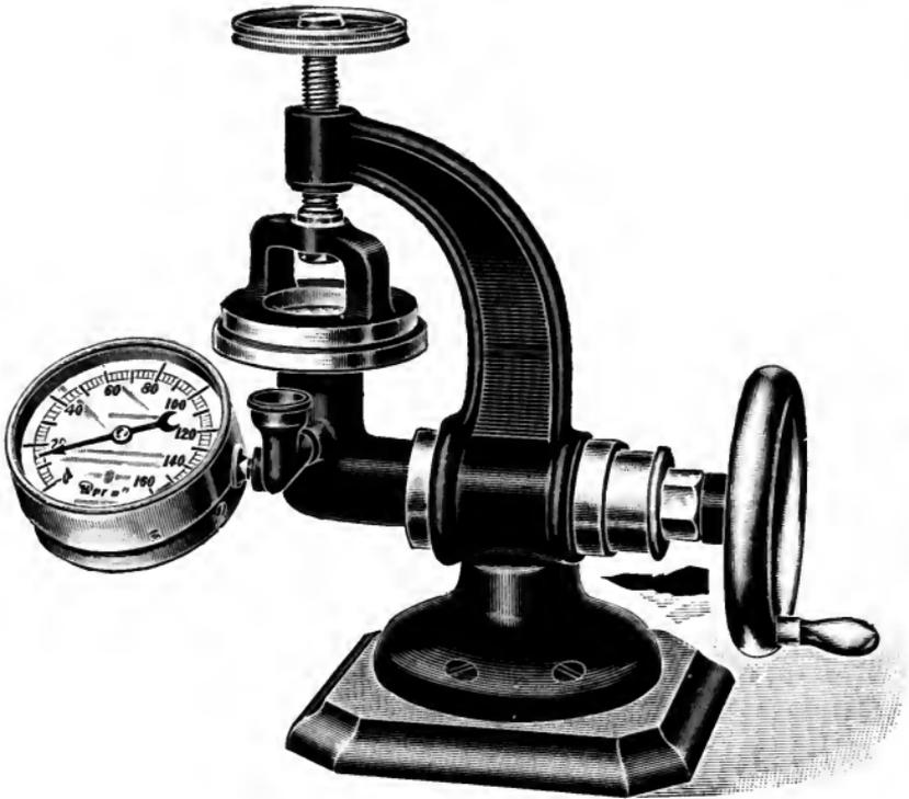
FIG. 25. EDWARDS' HYDROSTATIC PAPER TESTER
