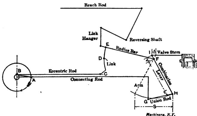
Fig. 26. Diagram of the Walschaerts Valve Gear
