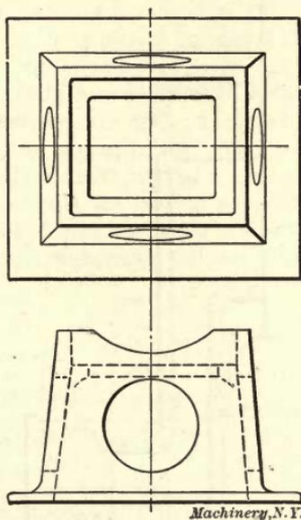
Fig. 27. Cast-iron Anvil Block
