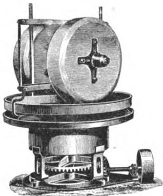
FIG. 12a. — MULLER STONES FOR GRINDING.
