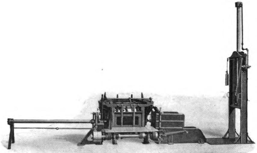
FIG. 43. — FRENCH COMBINED TRIMMER AND PACKER.
