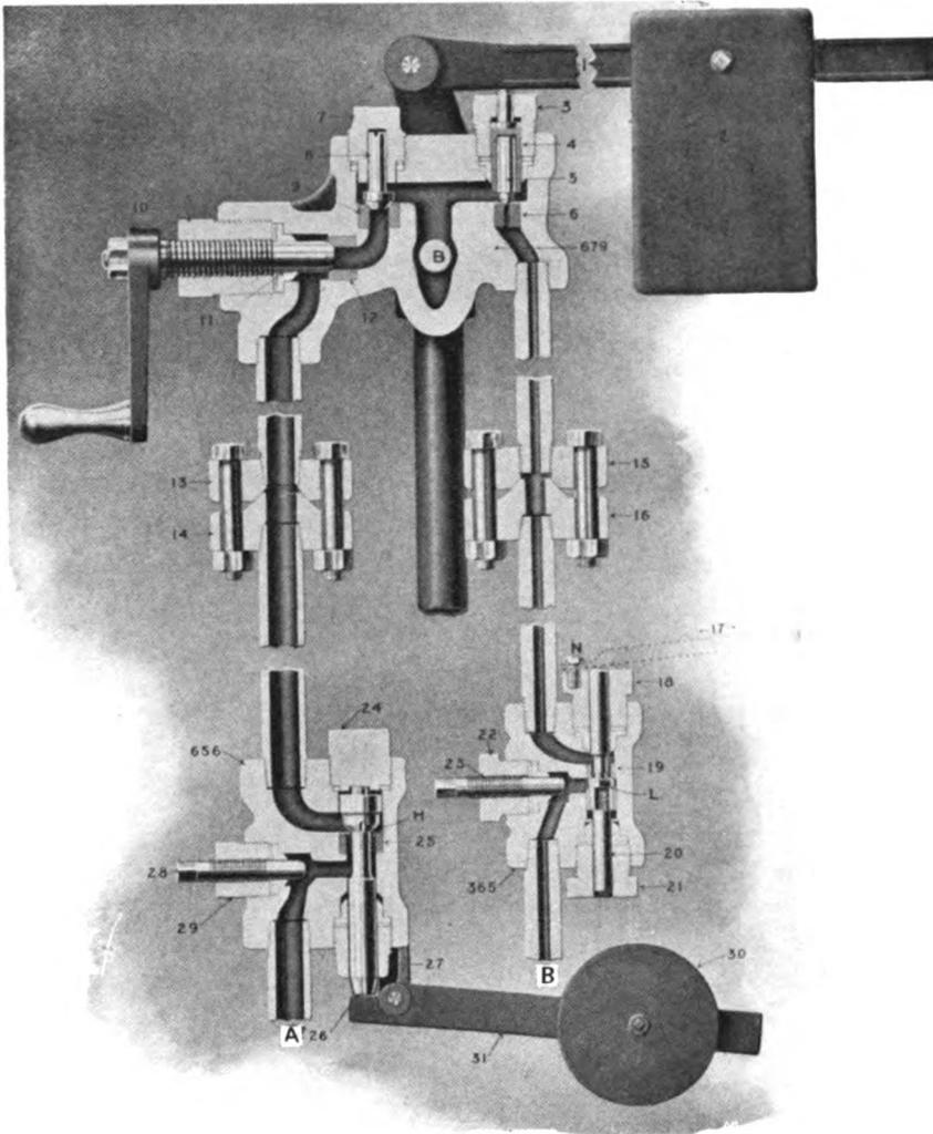
FIG. 31. — DETAILS OF FRENCH AUTOMATIC CHANGE VALVE.
