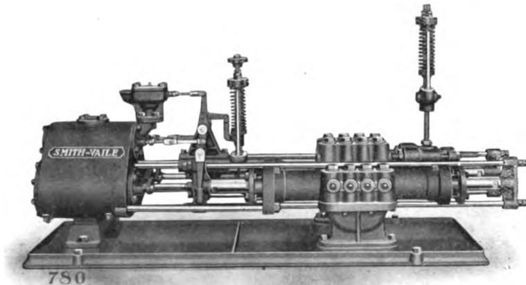
FIG. 27c. — DUPLEX HYDRAULIC PUMP.
