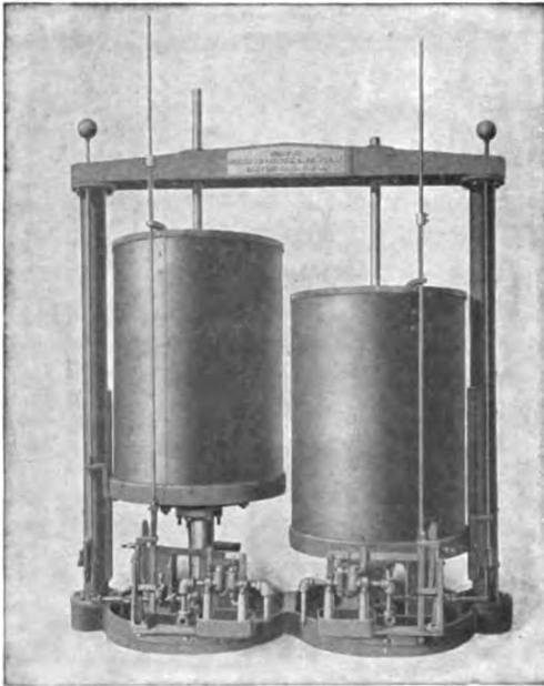
FIG. 29. — HYDRAULIC ACCUMULATORS.
