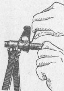
Bild 25 Abnehmen des Mündungsfeuerdämpfers
