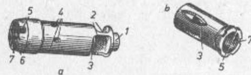
Bild 5 Mündungsbremsekompensator und Mündungsfeuerdämpfer
