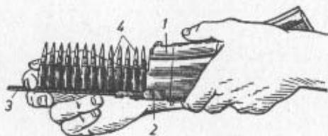
Bild 44 Füllen des Magazins aus dem Ladestreifen
