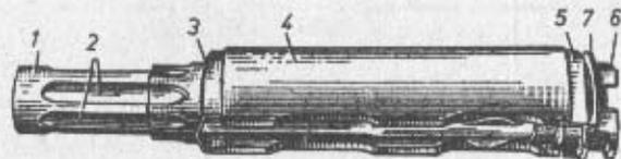
Bild 14 Führungsrohr und oberer Handschutz
