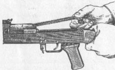
Bild 27 Herausnehmen der Schließereinrichtung
