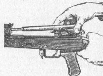
Bild 28 Herausnehmen der Schloßführung mit Schloß
