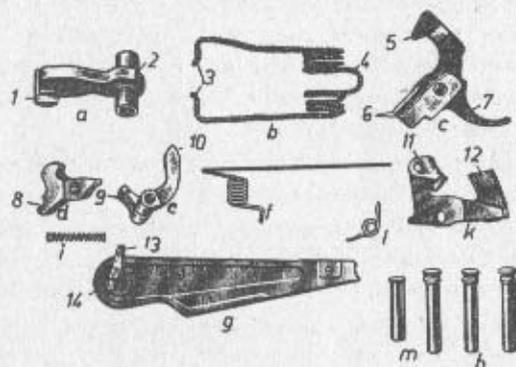
Bild 16 Teile der Abzugseinrichtung
