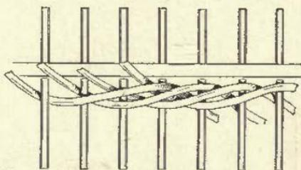
FIG. 24. ROPE TWIST.
