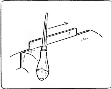
Fig. 156. Sharpening a Cabinet-Scraper:
