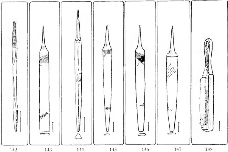
Fig. 142. Auger-Bit-File.
