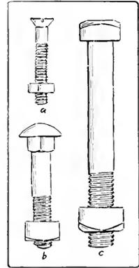
Fig. 230. a. Stove-bolt. b. Carriage-bolt. c. Machine-bolt.
