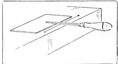
Fig. 157. Resharpener a Cabinet-Scraper:
