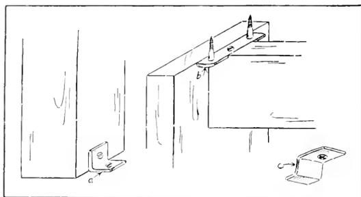
Fig. 232. a. Corner-iron. b. Straight plate. c. Panel-iron.
