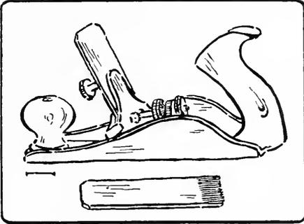
Fig. 111. Scratch-Plane and Scraper-Plane.
