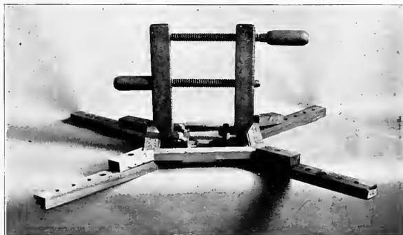
Fig. 254. Picture-Frame-Clamp.
