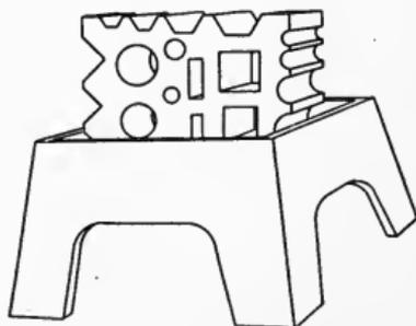
Fig. 20. THE SWAGE BLOCK.
