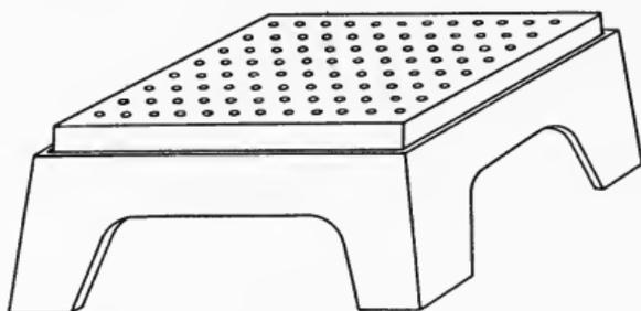
Fig. 23. THE SURFACE PLATE.
