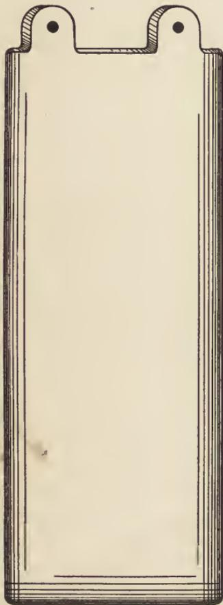
Fig. 49. Nickel Anode
