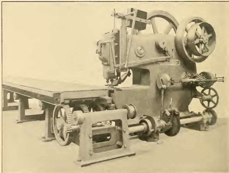
26" PUNCHING MACHINE—WITH AUTOMATIC SPACING TABLE.
