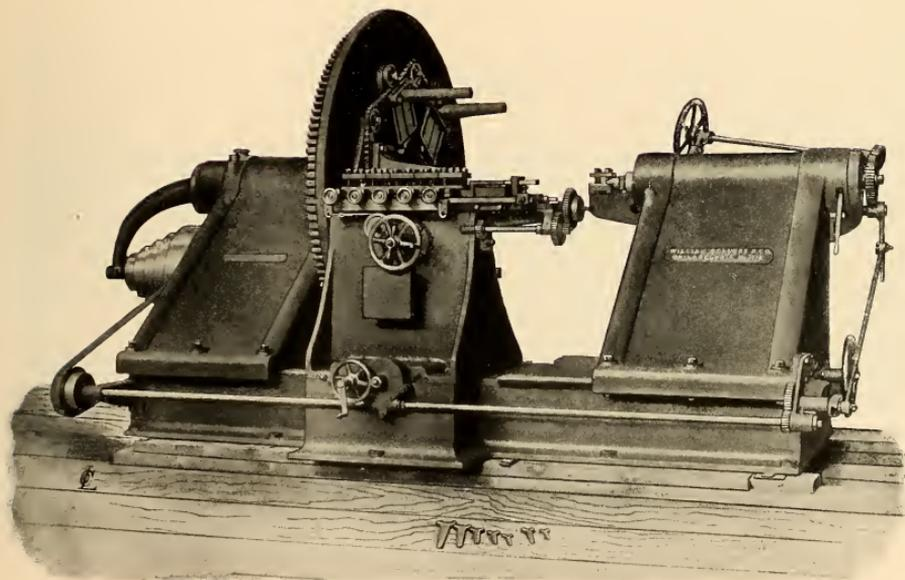
96" SPECIAL PULLEY LATHE.
