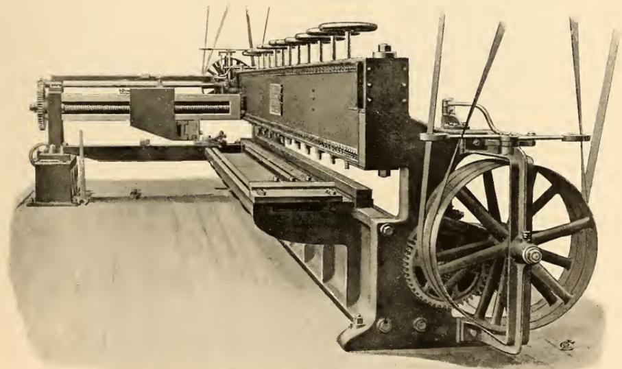
PLATE-PLANING MACHINE—FOR PLATES 22 FEET LONG.
