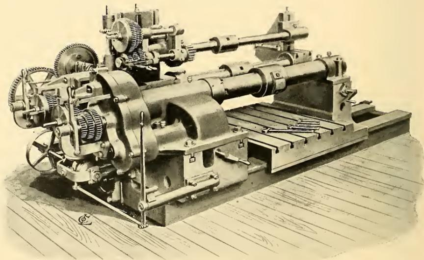
TRIPLE BORING MACHINE—FOR CYLINDERS OF COMPOUND LOCOMOTIVES.
