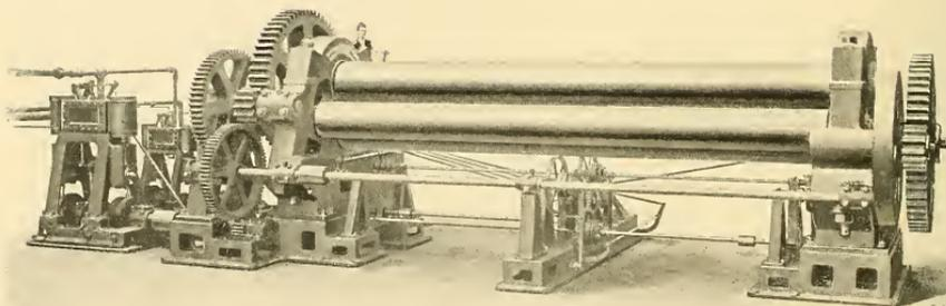
24" SHIP-PLATE ROLLS.—22 FEET 6" BETWEEN HOUSINGS.
