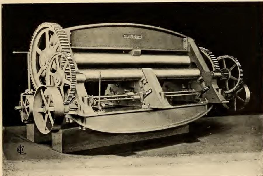
16" SHIP-PLATE ROLLS.—14 FEET BETWEEN HOUSINGS.
