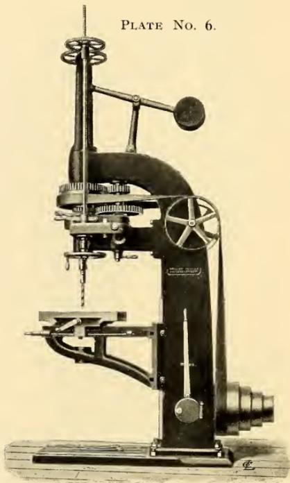
45" VERTICAL, DRILLING MACHINE—WITH COMPOUND TABLE.
