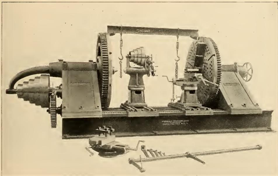
66" WHEEL-TURNING LATHE.
