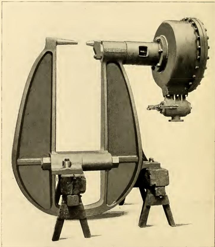
5-FT. STEAM RIVETING MACHINE—WITH EXTRA WIDE GAP.
