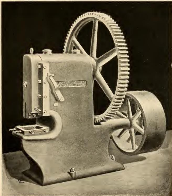
CRANK PUNCHING MACHINE—7" OVERREACH.
