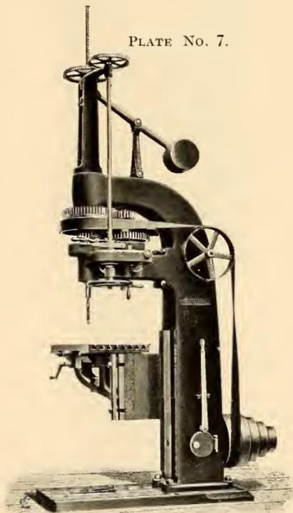
45" VERTICAL DRILLING MACHINE—WITH COMPOUND TABLE.
