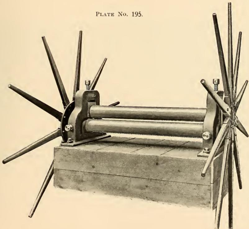
8" HAND BENDING ROLLS.—FOR LIGHT PLATES.
