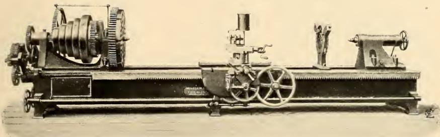
36" LATHE.—TRIPLE-GEARED, TURNING AND SCREW-CUTTING FEEDS.
