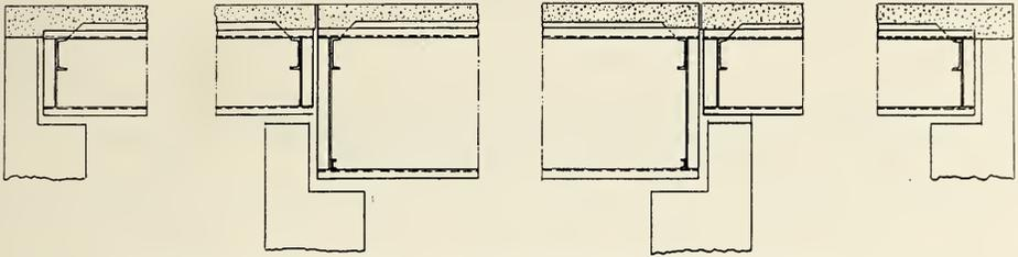
PART LONGITUDINAL SECTION SHOWING GIRDER ENDS - PIERS - HAUNCHES.
