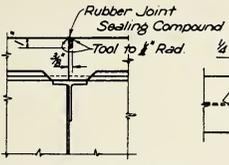
**CONSTRUCTION JOINT DETAIL**
