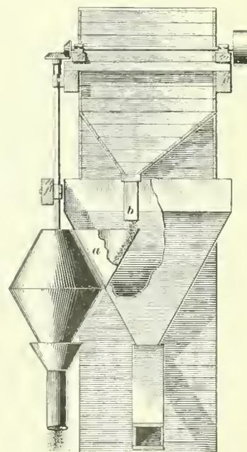
FIG. 3. VEZIN SAMPLER
