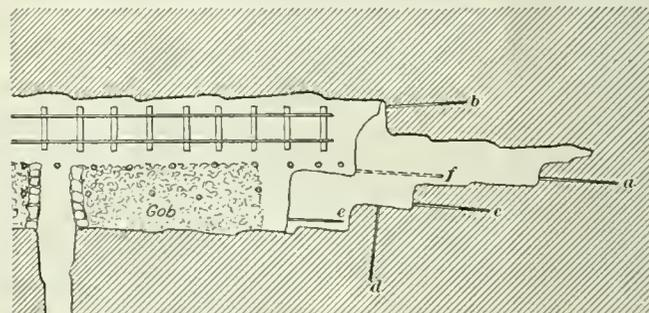
FIG. 4. PLAN OF TRIPLE-BENCH ENTRY
