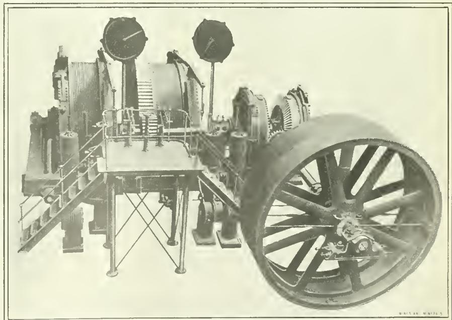
FIG. 4. ELECTRIC ROPE-DRIVE HOIST
