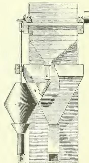
FIG. 3. VEZIN SAMPLER
