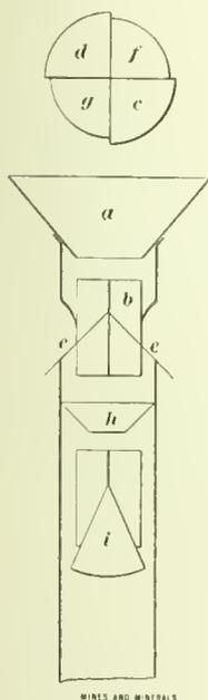
FIG. 1. PIPE SAMPLER
