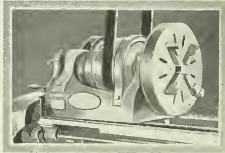
FIG. 1. GEAR GUARD
