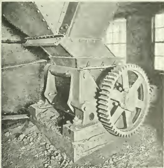
FIG. 1. SINGLE-ROLL CRUSHER
