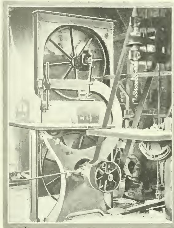
FIG. 3. BAND SAW GUARD
