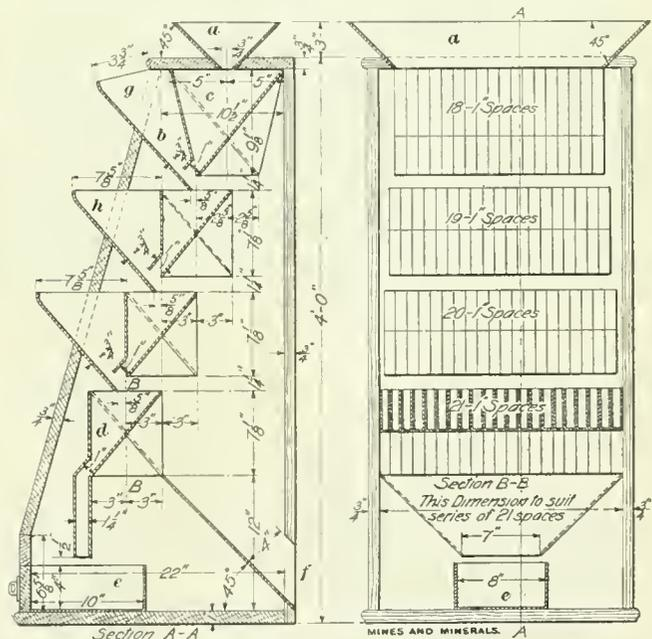
FIG. 1. LABORATORY COAL SAMPLER
