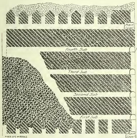
FIG. 4. LONGITUDINAL SECTION OF SUBSTOPING
