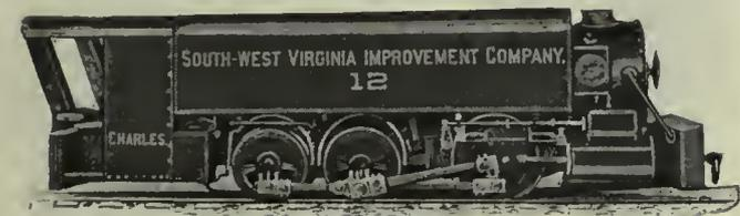
FIG. 52. STEAM MINE LOCOMOTIVE
