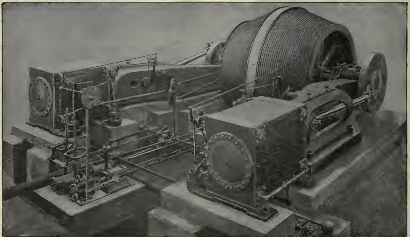
FIG. 21. FIRST-MOTION HOIST, MAXWELL SHAFT, ASHLEY, PA.
