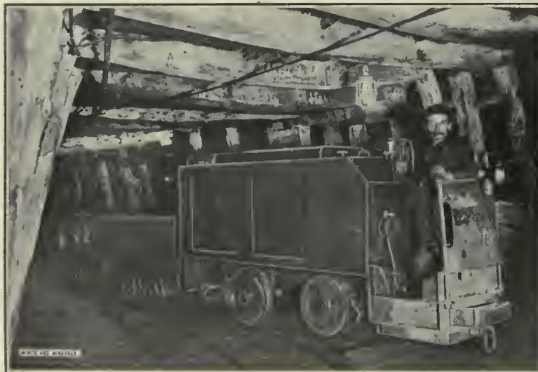
FIG. 1. GASOLINE MINE LOCOMOTIVE
