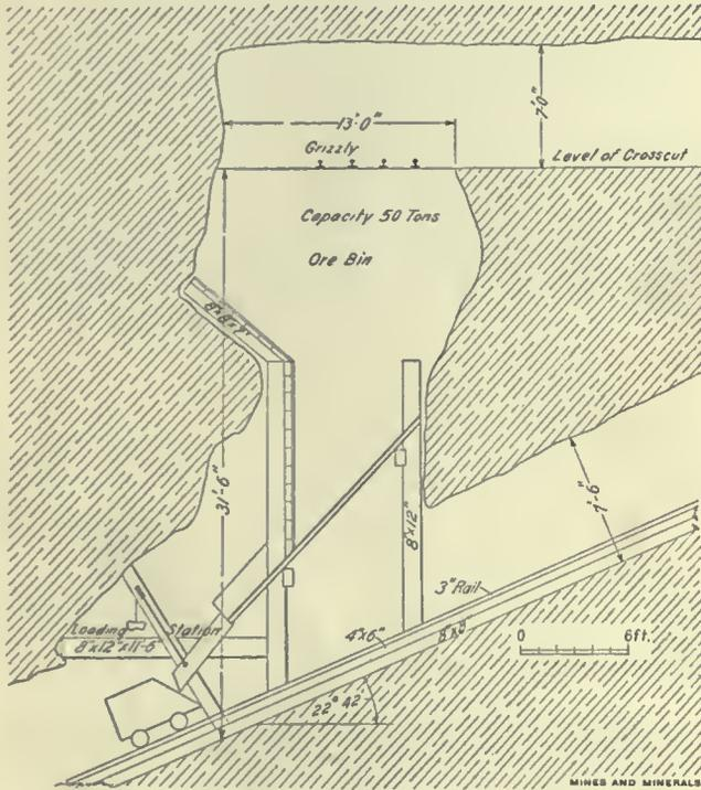
FIG. 5. UNDERGROUND ORE BIN
