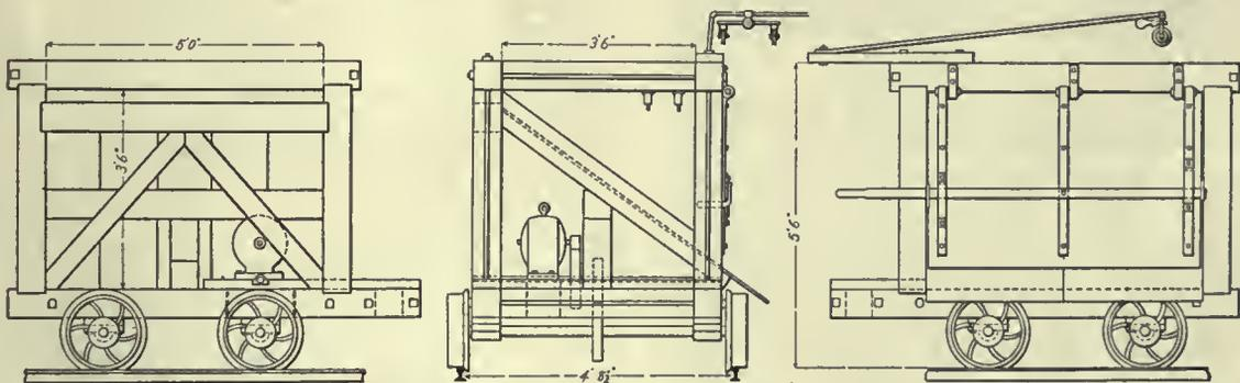
FIG. 7. TROLLEY ORE CAR
