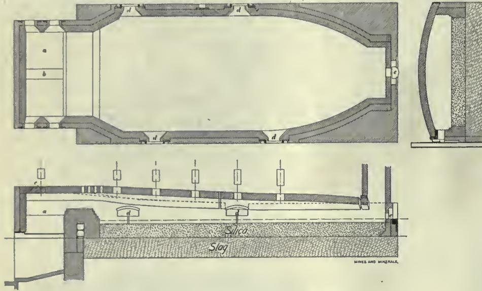
FIG. 3. LARGE REVERBERATORY FURNACE FOR SMELTING MATTE
