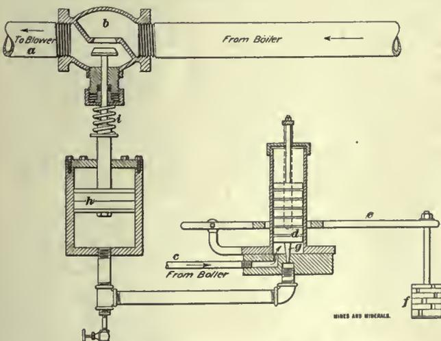
FIG. 6. BOILER PRESSURE REGULATOR
