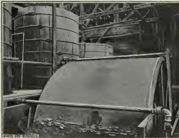
FIG. 5. THE OLIVER FILTER
