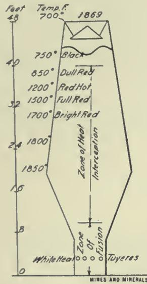
FIG. 8. IRON BLAST FURNACE
