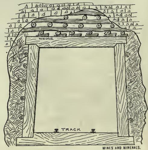
FIG. 3. TIMBERING IN SOFT GROUND
