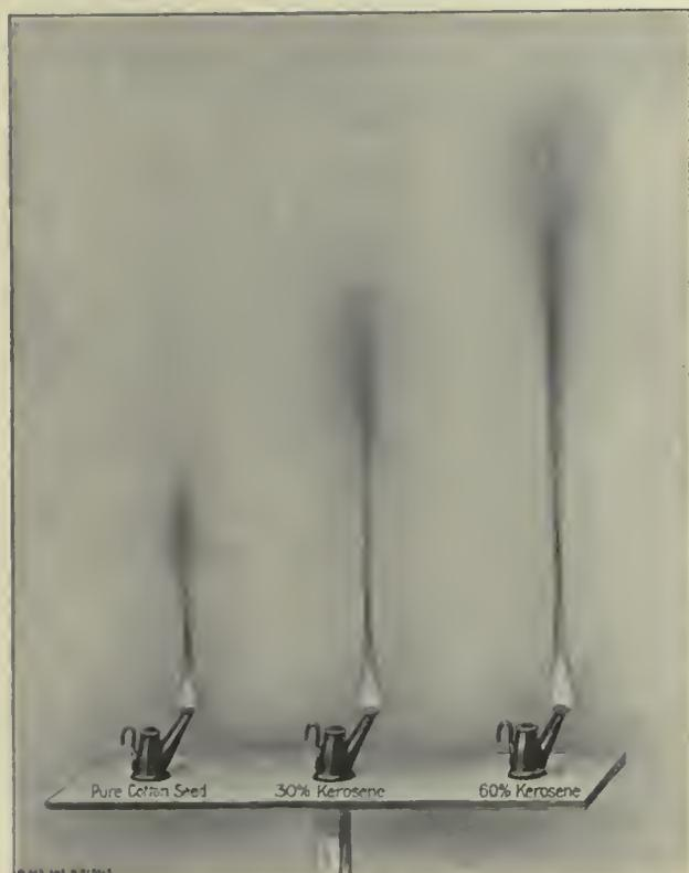
FIG. 1. EFFECT OF KEROSENS IN LAMP OIL
