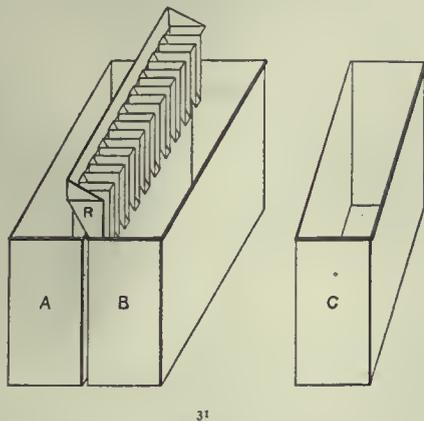
FIG. 1. RIFFLE SAMPLER
