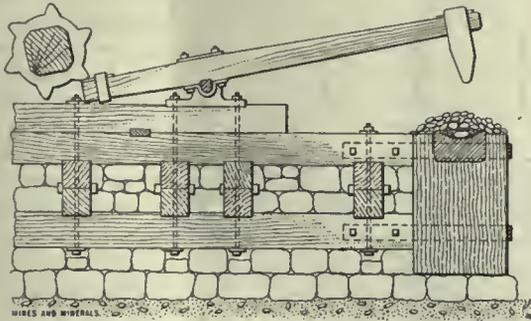
FIG. 4. ANCIENT TRIP HAMMER FOR BREAKING ORE
