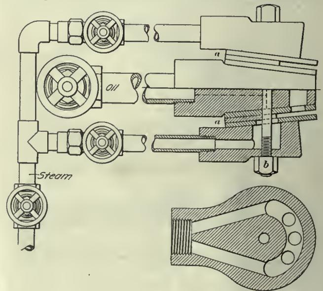
FIG. 4. KITTLE OIL BURNER
