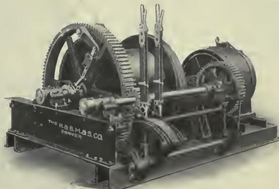
FIG. 2. SINGLE DRUM HOIST
