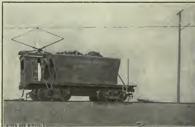
FIG. 2. ELECTRIC ORE CARS
