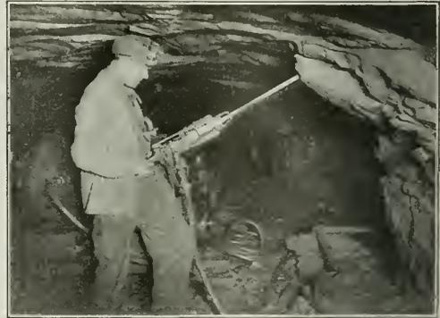
FIG. 10. DRILL DRIVEN BY ELECTRIC COMPRESSOR
