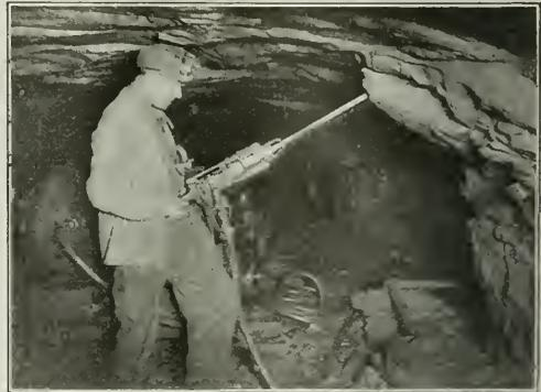
FIG. 10. DRILL DRIVEN BY ELECTRIC COMPRESSOR
