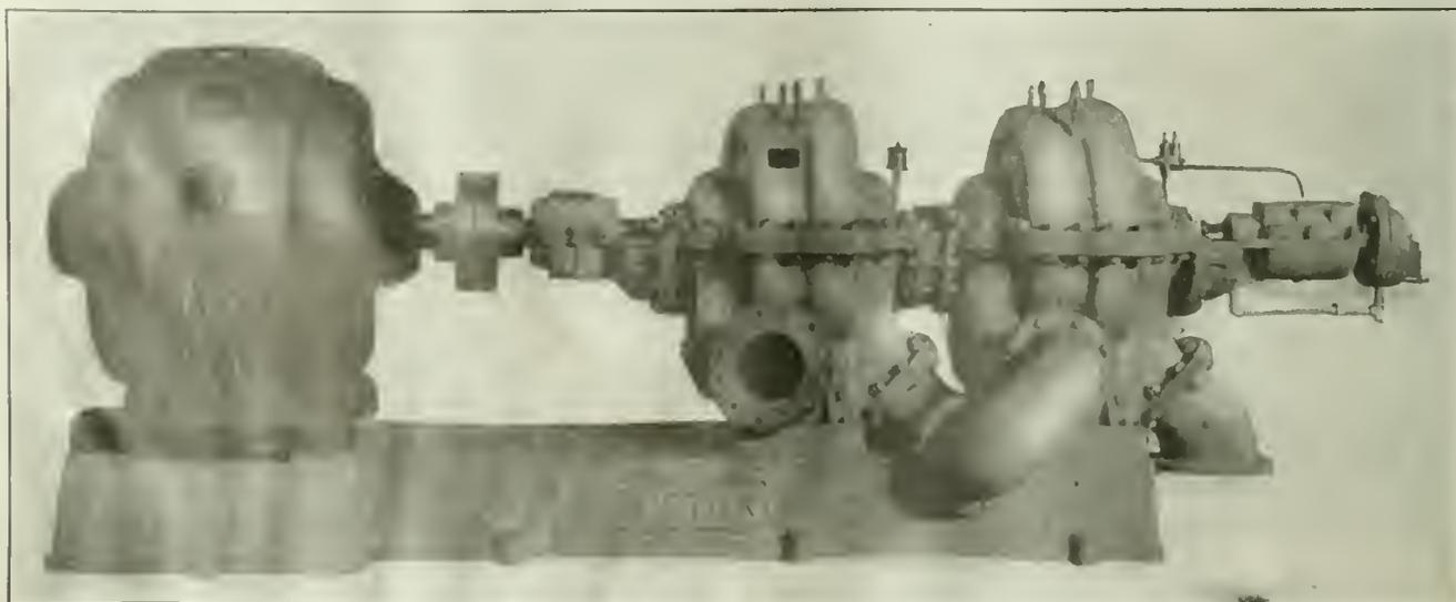
HYDRAULICALLY-BALANCED, ELECTRICALLY-DRIVEN PUMP
