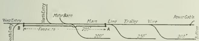
PLAN OF A TROLLEY-HAULAGE SYSTEM
