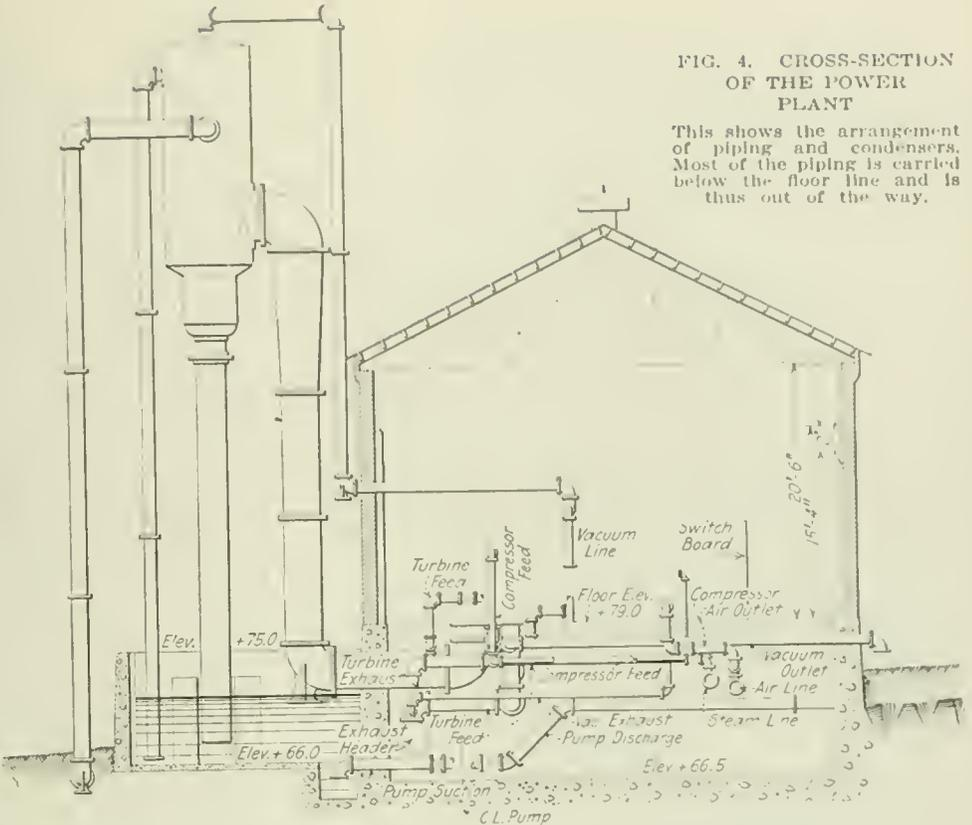
FIG. 4. CROSS-SECTION OF THE POWER PLANT
