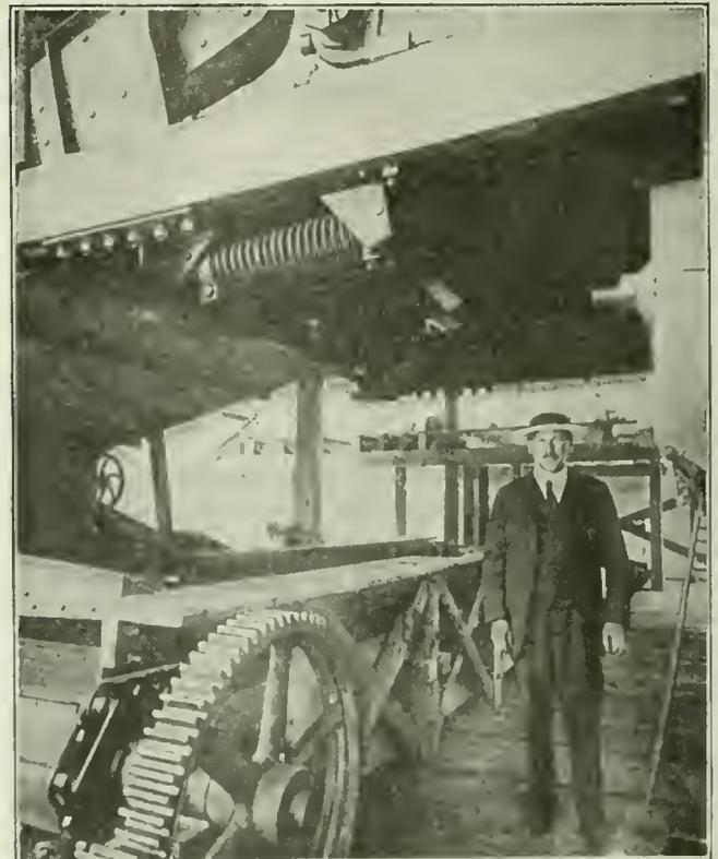
FIG. 5. BALANCE SPRINGS ON THE SHAKING SCREENS
