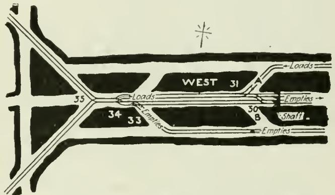
FIG. 1. POORLY-PLANNED SHAFT BOTTOM
