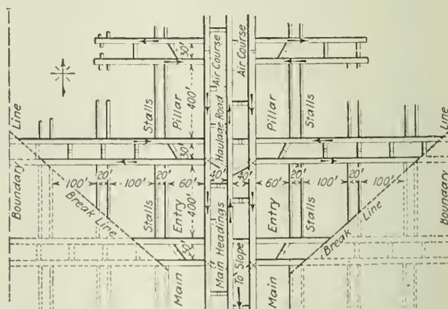
MINING THE COAL ON THE RETREATING PLAN
