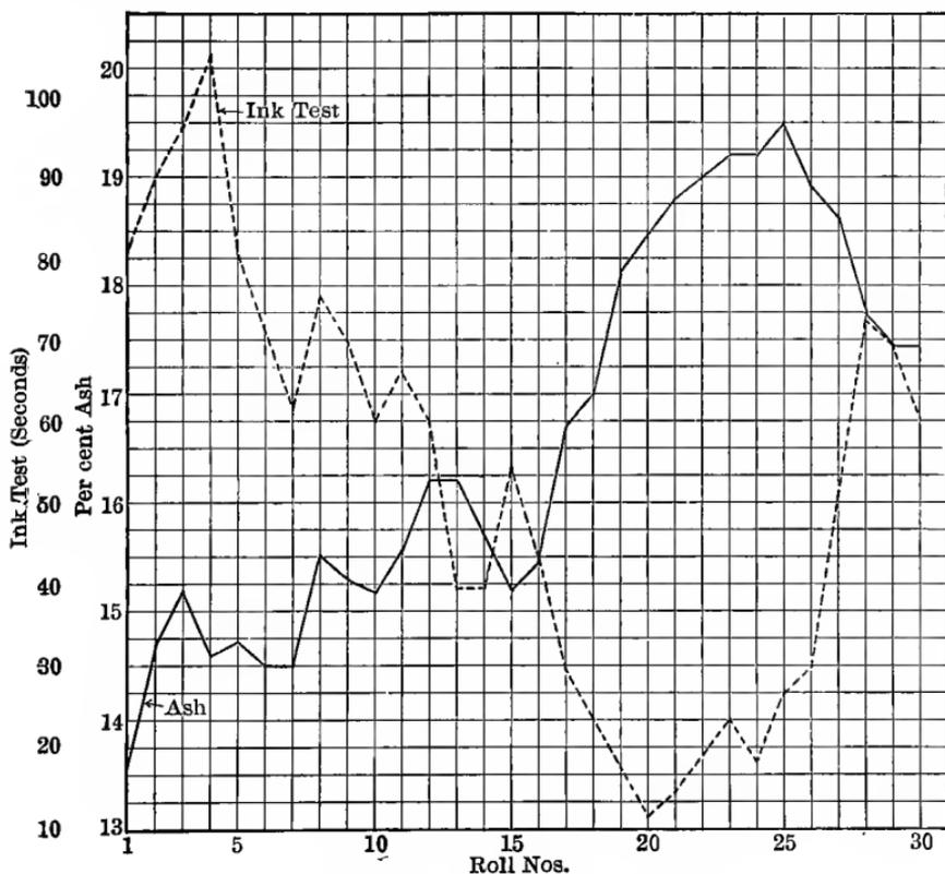
FIG. 36. EFFECT OF FILLER ON SIZING
