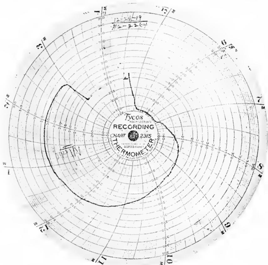
FIG. 30. TEMPERATURE RECORD OF A SULPHITE COOK
