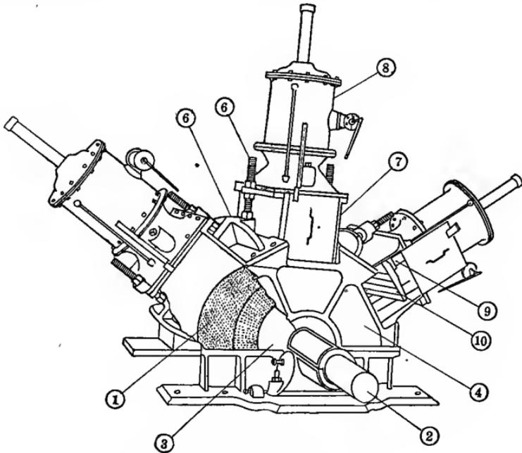
FIG. 31. THREE-POCKET GRINDER
