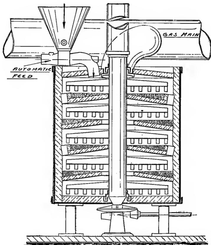
FIG. 25. HERRESHOFF PYRITES BURNER
