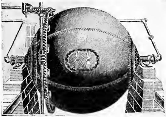
FIG. 5. SPHERICAL RAG BOILER
