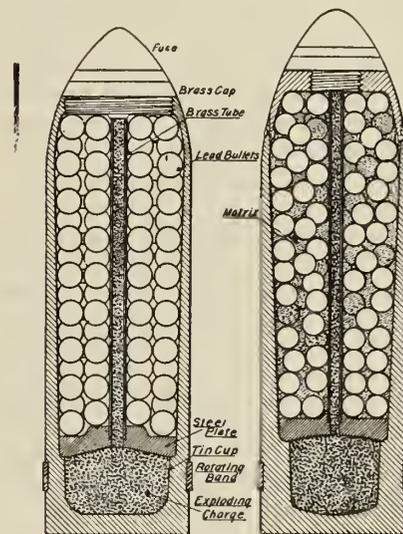
FIG. 2. TYPICAL FORMS OF COMMON SHRAPNEL.
