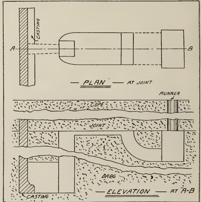
BLOCK GATE ENTERING CASTING AT BOTTOM.
