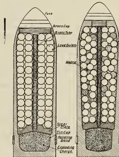
FIG. 2. TYPICAL FORMS OF COMMON SHRAPNEL.
