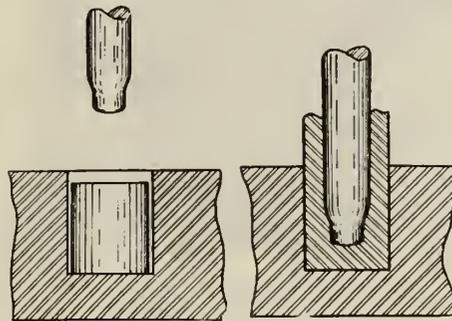
SHELL FORGING—FIRST OPERATION OF PIERCING THE BILLET.
