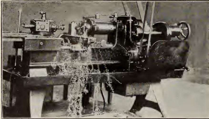
FIG. 18. FINISHING BACK ENDS OF 18-PDR. SHRAPNEL SHELL CARTRIDGE CASES ON A WARNER & SWABEY BRASS TURNING TURRET LATHE.
