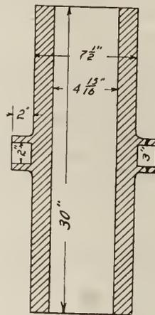
FIG. 3. INGOT MOLD.
