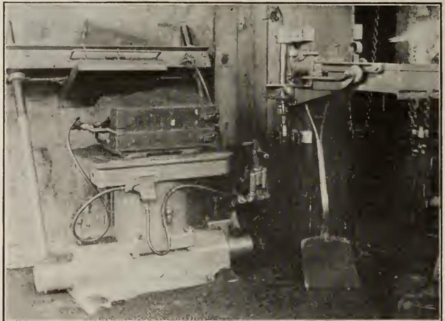
PNEUMATIC SIFTER SHOWN DRAWN BACK, READY TO SQUEEZE MOLD.
