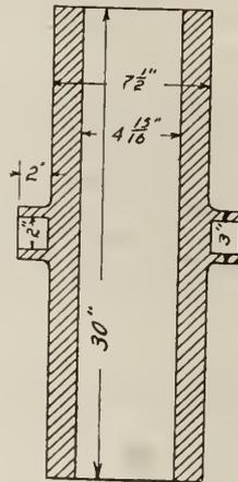
FIG. 3. INGOT MOLD.
