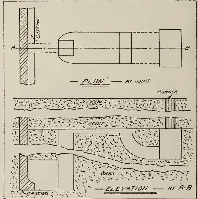
BLOCK GATE ENTERING CASTING AT BOTTOM.
