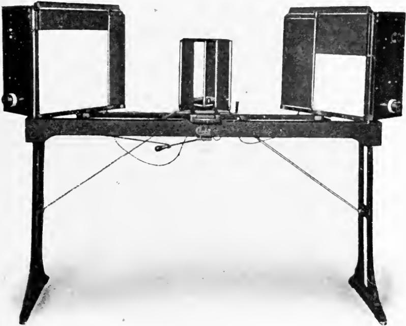
FIG. 135.—WHEATSTONE STEREOSCOPIC ILLUMINATOR.
