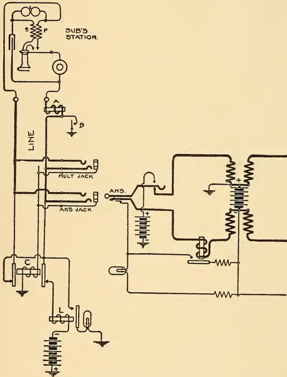
FIG. 346.—CIRCUIT OF STROUD COIN-COLLECTING SYSTEM.
