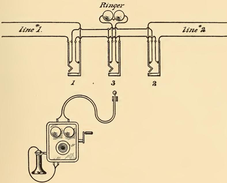
FIG. 200.—CIRCUITS OF TOLL CUT-IN STATION.
