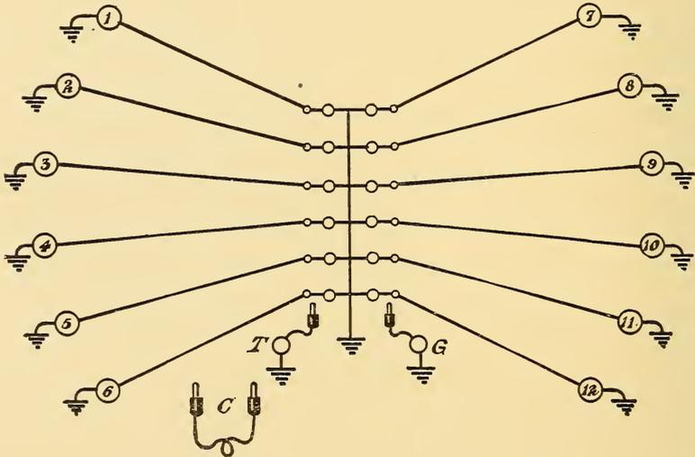
FIG. 154.—GROUNDED-CIRCUIT SWITCH-BOARD.
