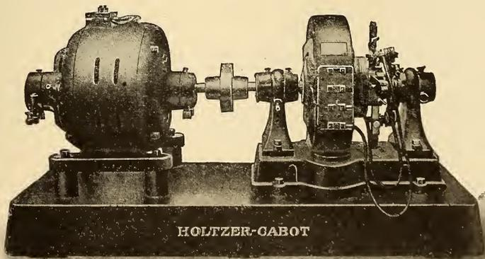
FIG. 408.—CHARGING MOTOR GENERATOR—ALTERNATING-CURRENT MOTOR.
