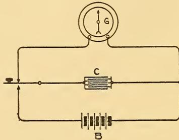
FIG. 638.—CAPACITY TEST.
