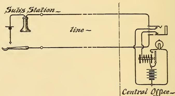
FIG. 239.—LINE CIRCUIT.
