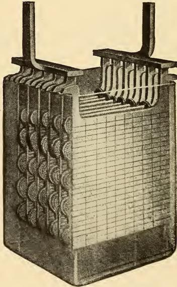
FIG. 412.—ELEVEN-PLATE CHLORIDE CELL.
