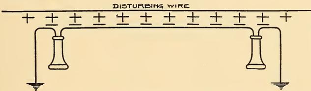
FIG. 141.—ELECTROSTATIC INDUCTION.
