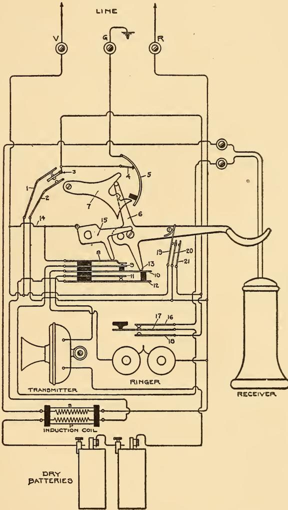
FIG. 511.—CIRCUITS OF SUBSCRIBER'S INSTRUMENT.
