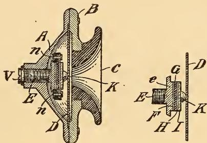
FIG. 17.—PHELPS-EDISON TRANSMITTER.
