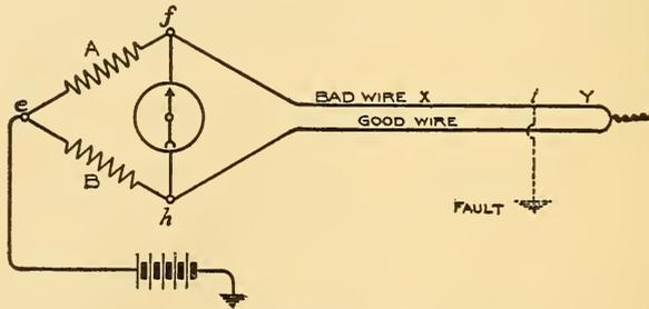
FIG 643.—MURRAY LOOP TEST.
