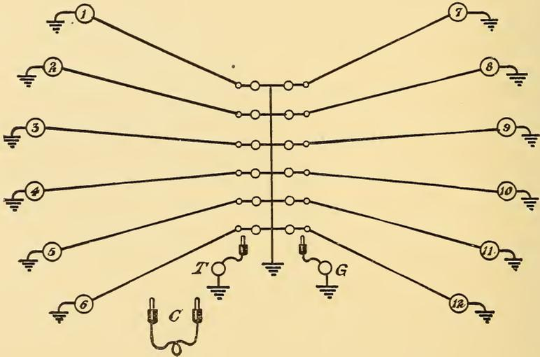
FIG. 154.—GROUNDED-CIRCUIT SWITCH-BOARD.
