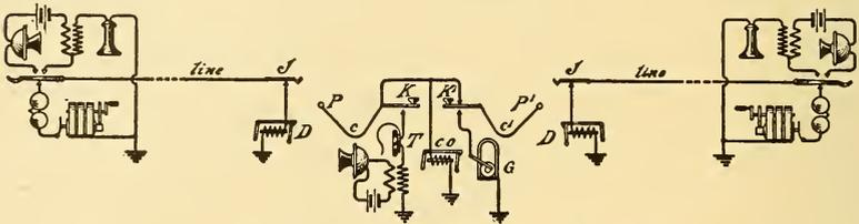
FIG. 158.—CIRCUITS MAGNETO SWITCH-BOARD—NORMAL.
