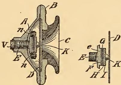
FIG. 17.—PHELPS-EDISON TRANSMITTER.
