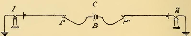
FIG. 226.—SERIES COMMON BATTERY TRANSMISSION—GROUNDED.
