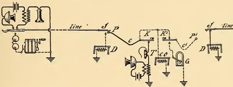
FIG. 160.—CIRCUITS MAGNETO SWITCH-BOARD—OPERATOR ANSWERING.
