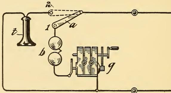
FIG. 106.—HAND-SWITCH CIRCUIT.
