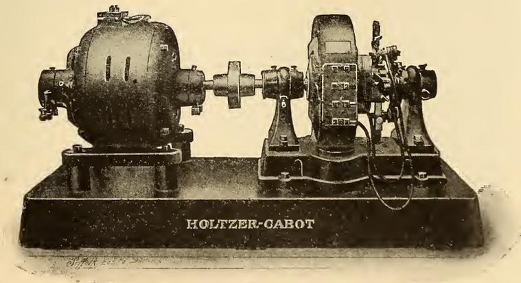
FIG. 408.—CHARGING MOTOR GENERATOR—ALTERNATING-CURRENT MOTOR.
