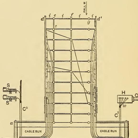
FIG. 448.—END VIEW HIBBARD DISTRIBUTING FRAME.
