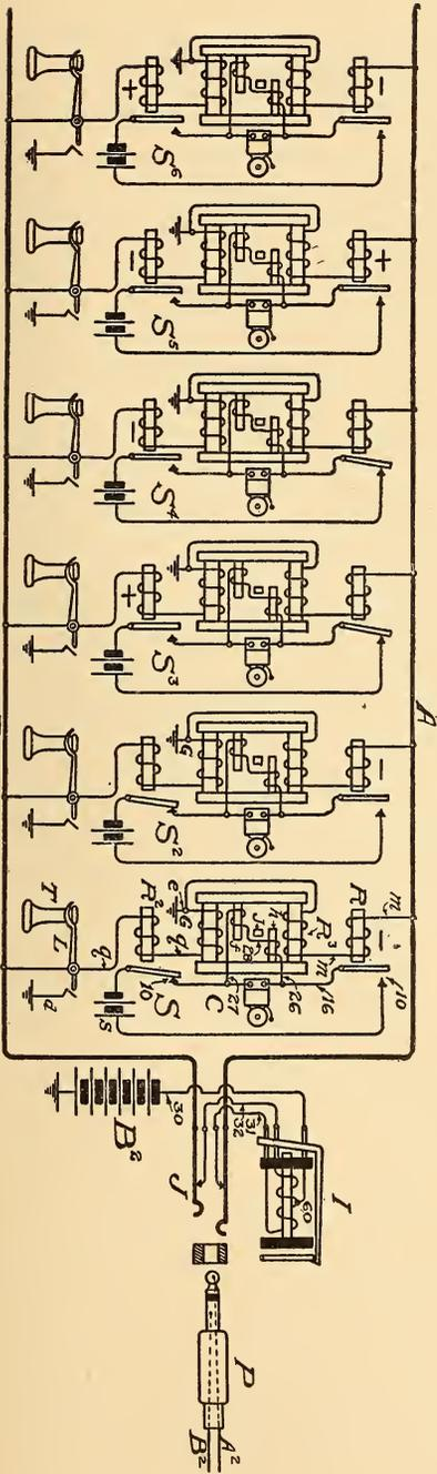
FIG. 330.—CIRCUITS OF SIX-STATION B.W.C. SYSTEM.
