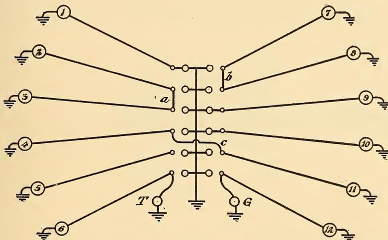
FIG. 155.— GROUND-CIRCUIT SWITCH-BOARD.
