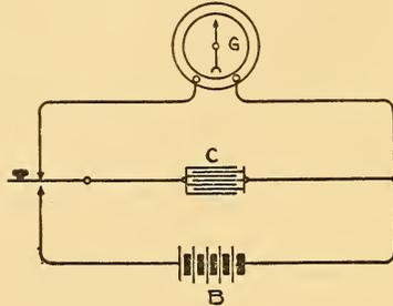
FIG. 638.—CAPACITY TEST.
