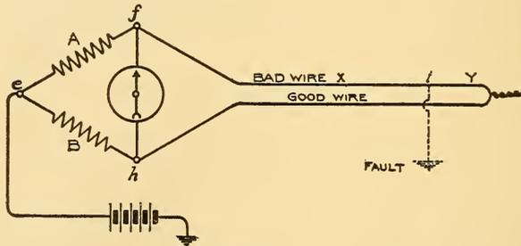
FIG 643.—MURRAY LOOP TEST.
