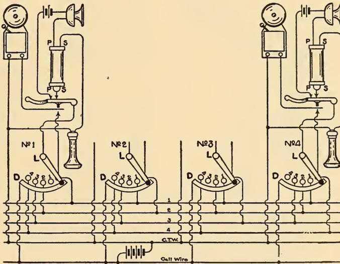
FIG. 525.—CIRCUITS OF HOLTZER-CABOT SYSTEM.
