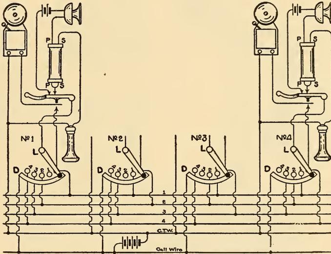
FIG. 525.—CIRCUITS OF HOLTZER-CABOT SYSTEM.
