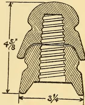
FIG. 545.—DOUBLE-GLASS TRANSPOSITION INSULATOR.
