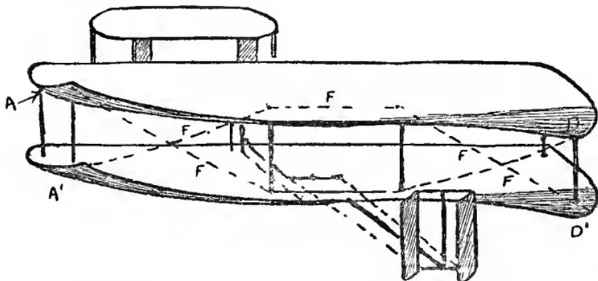
THE WARPING ARRANGEMENT ON THE WRIGHT AEROPLANE
