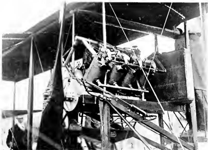
PROPELLER AND EIGHT-CYLINDER ENGINE OF THE CURTISS AEROPLANE
