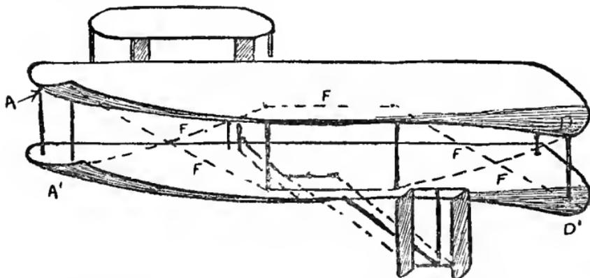
THE WARPING ARRANGEMENT ON THE WRIGHT AEROPLANE
