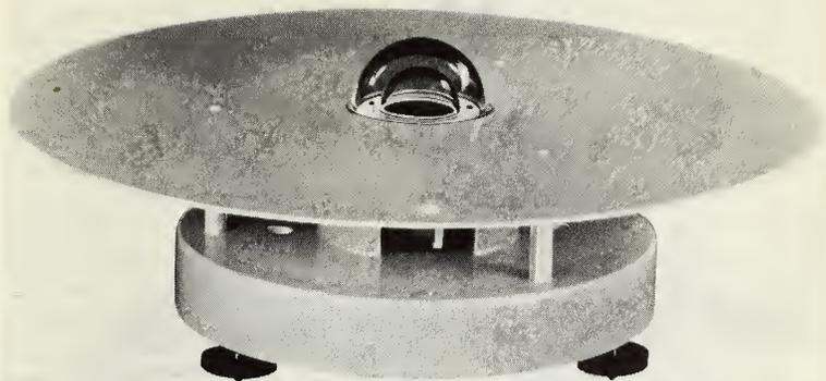
Fig. 5-4. Kipp & Zonen solarimeter.
