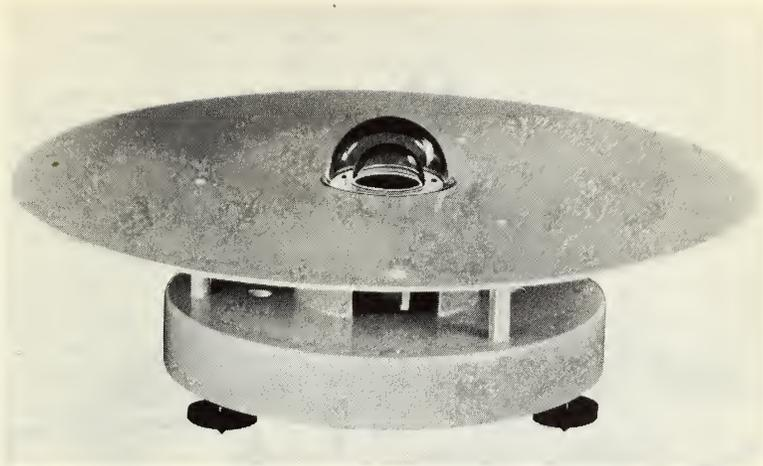
Fig. 5-4. Kipp & Zonen solarimeter.
