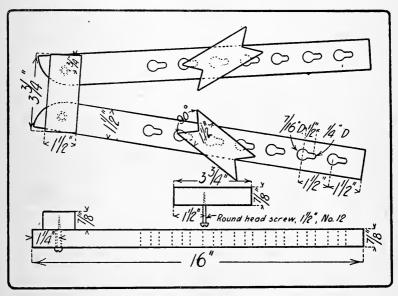
Fig. 7. Picture frame clamp.
