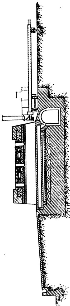
Fig. 67.—Coppée Coke Oven.
