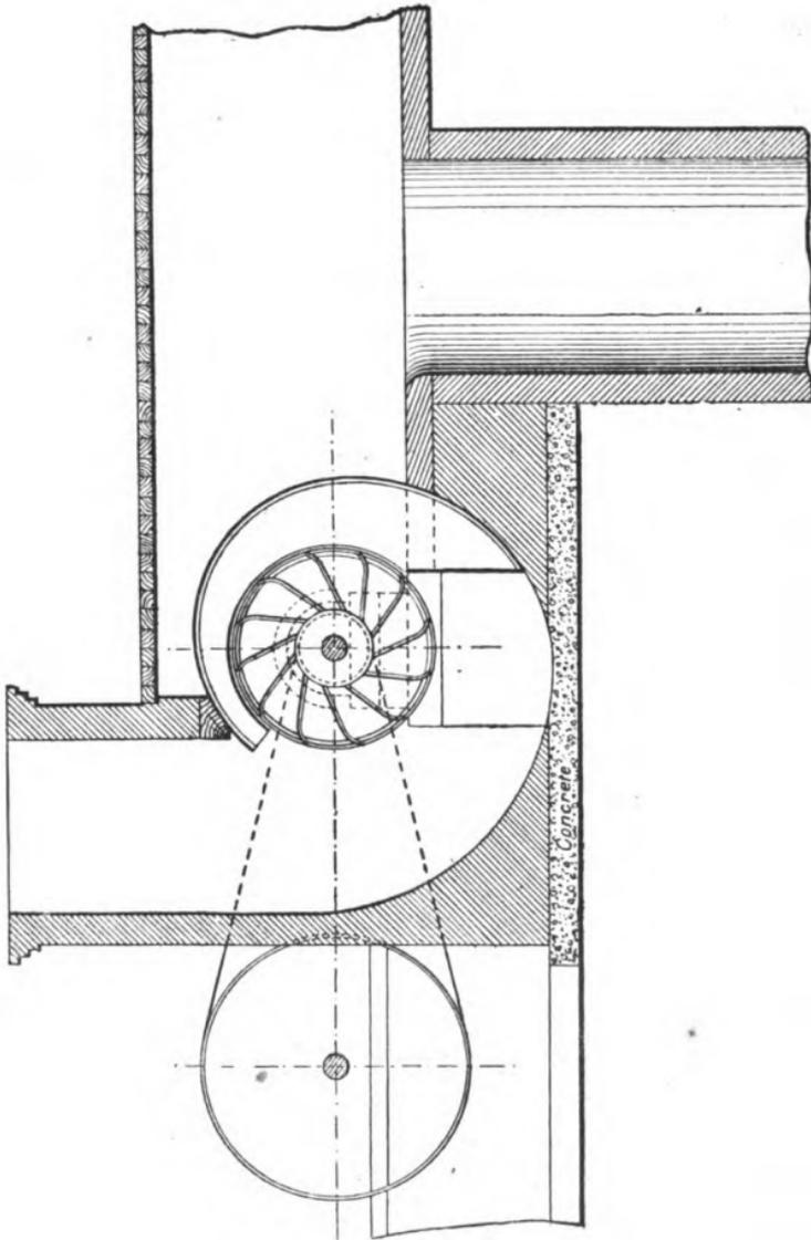
Fig. 59.—The Schiele Ventilating Fan.
