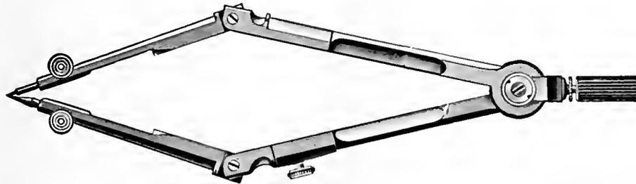
COMPASS IN POSITION FOR TESTING ALIGNMENT.
