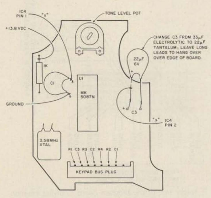
Fig. 10. The PCM-369 DTMF generator.
