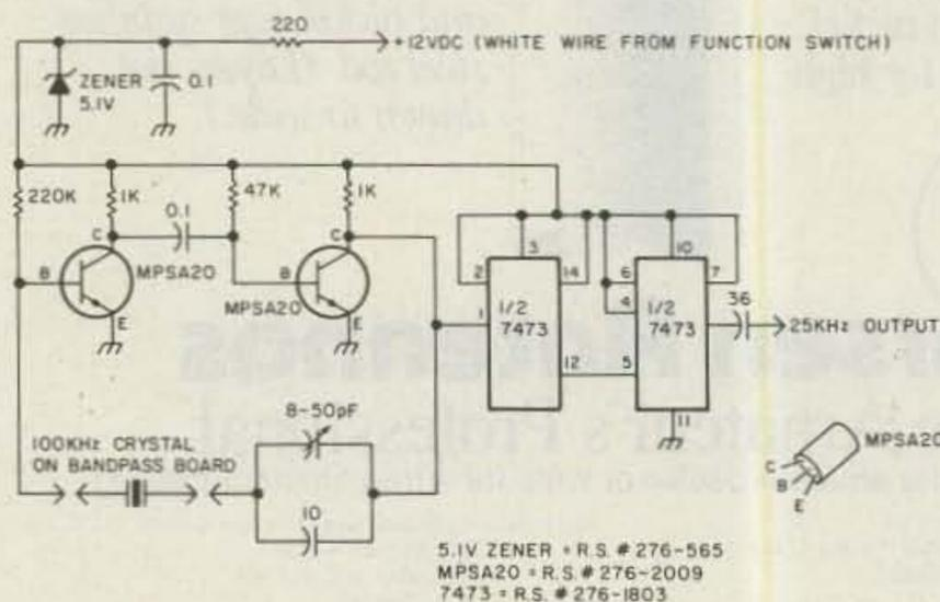
Fig. 1(a). 25-kHz crystal calibrator.
