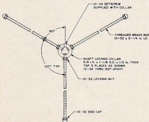
Fig. 2. Capacity hat detail.
