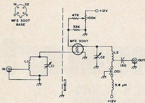
Fig. 1. 146 MHz rf amplifier.
