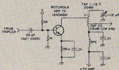
Fig. 30. 73 MHz doubler schematic
