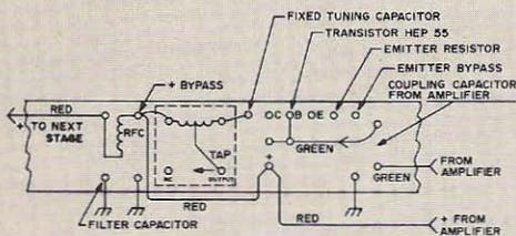
Fig. 27. Wiring diagram, 8 MHz tripler.
