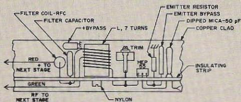
Fig. 29. 24 MHz tripler wiring diagram.
