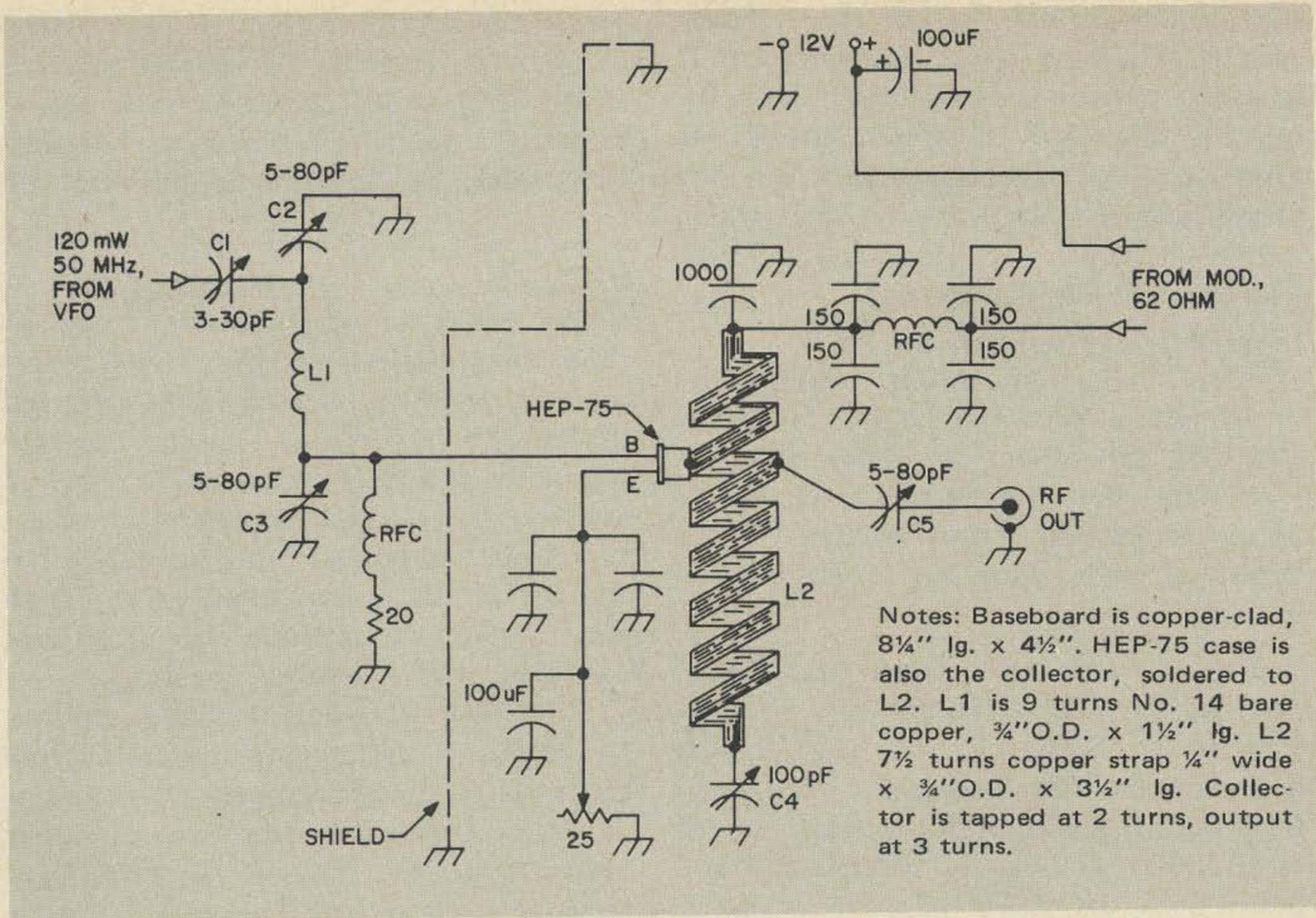
Fig. 1. 2 watt, crystal-heterodyne-VFO 6 meter rig.
