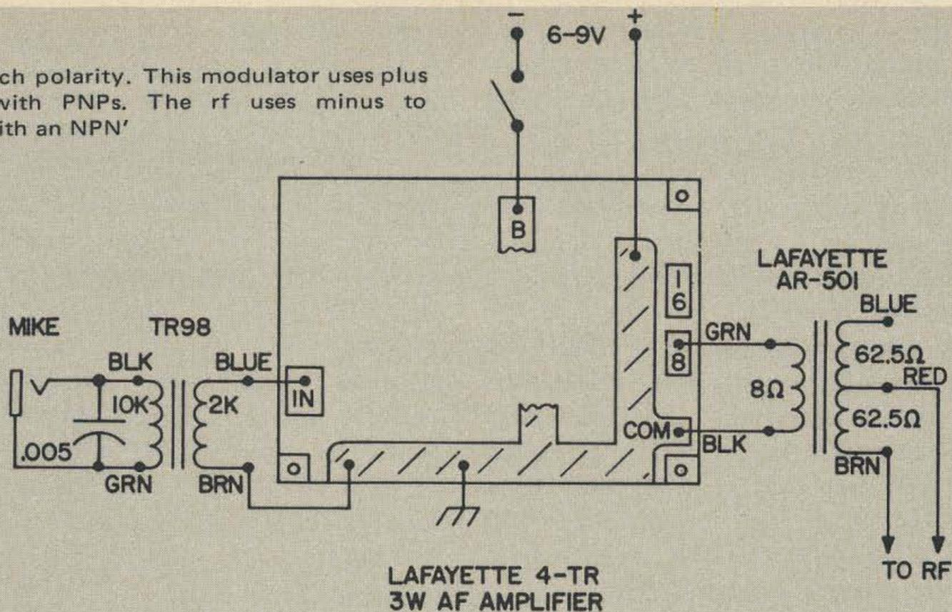
Fig. 4. Modulator circuit, 2 watt, 6 meter rig.
