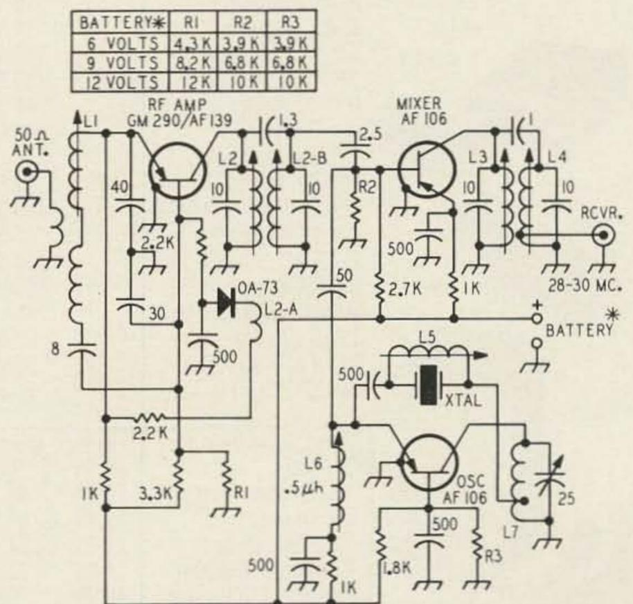
Fig. 1. Two meter converter.
