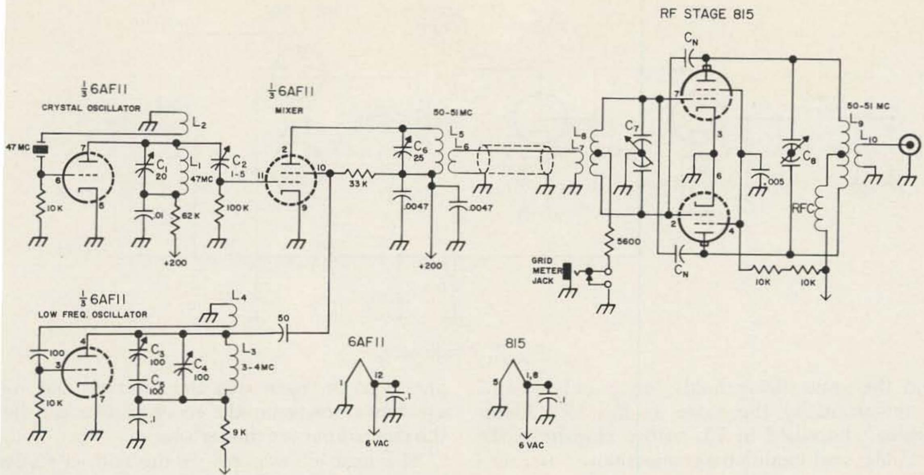
Fig. 1. 6 Meter Heterodyne Transmitter.
