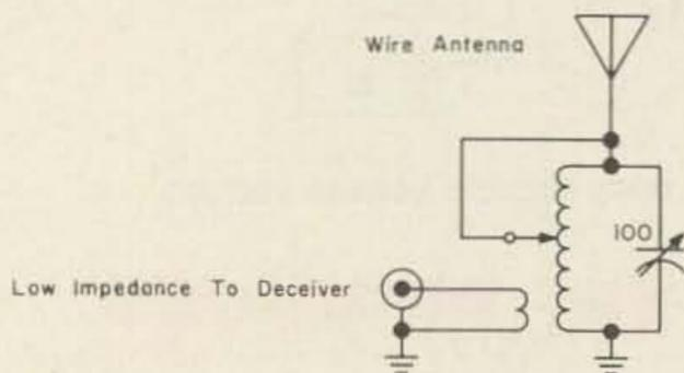
ANTENNA TUNER FOR RECEIVER DECEIVER
