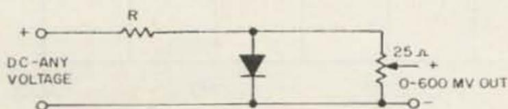
DIODE IS ANY SILICON-JUNCTION UNIT
